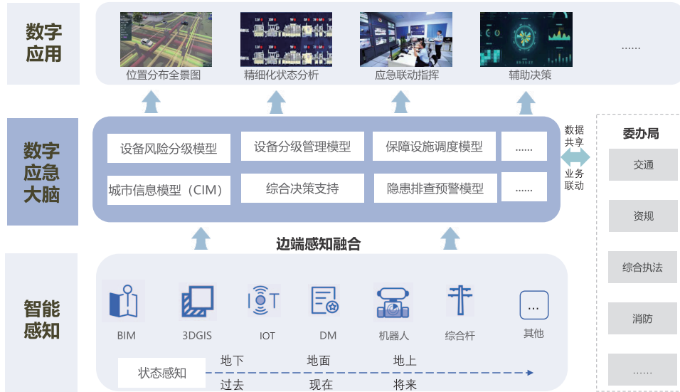
图 10 基础设施安全应急数字化架构
